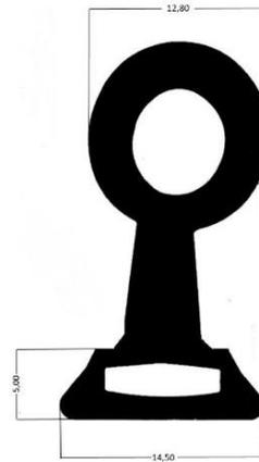
Artikel-Nr. 11008      Dichtungsgummi für Kühl-/Tiefkühlraumschiebetür Typ „EKS/ETS“
