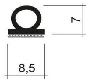
Artikel-Nr. 11974 Sanierungsdichtung für Kellertür Typ „KFE“
