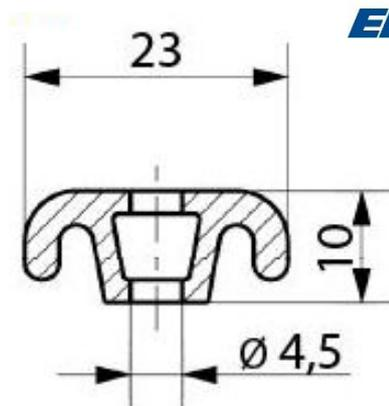
Artikel-Nr. 11734 Befestigungsleiste für Bodengummi Typ „LTS/LKS/LBS“
