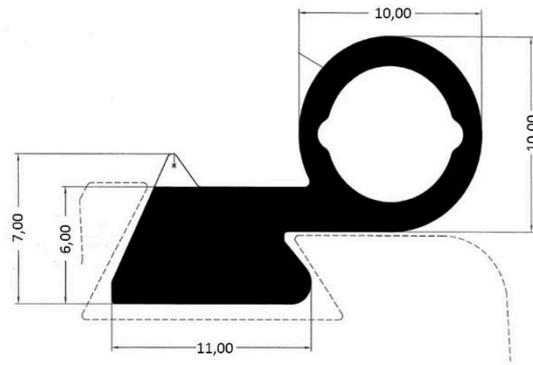
Artikel-Nr. 11006 Dichtungsgummi für Betriebsraum-Drehtür Typ „Gastro 2 KE“
