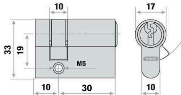
Artikel-Nr. 11916 Profilhalbzylinder für EURO 2000, 30/10 mm für Tiefkühlraum-Drehtür Typ „VE“
