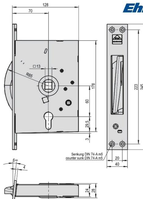
Artikel-Nr. 10943 Schneckenpresshebelschloss, DIN L für Tiefkühlraum-Drehtür Typ „VE“
