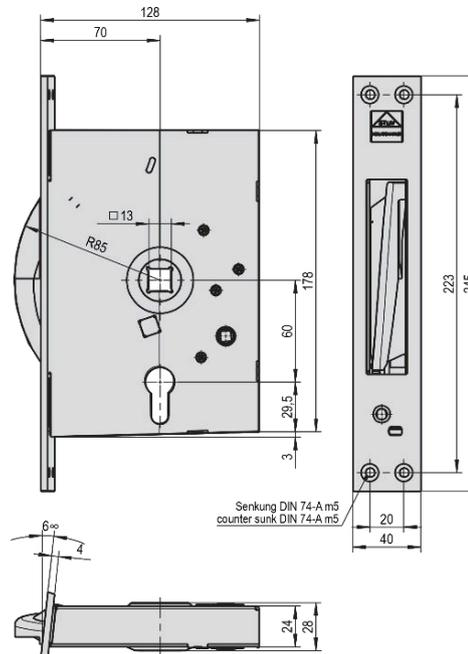
Artikel-Nr. 10942 Schneckenpresshebelschloss, DIN R für Tiefkühlraum-Drehtür Typ „VE“
