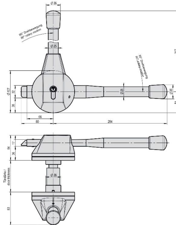
Artikel-Nr. 10178 EURO 2000 Presshebel für Kühlraumtür-Drehtür Typ „KE“ für Türblatt-Stärke 80-86 mm
