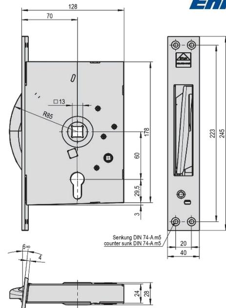
Artikel-Nr. 10943 Schneckenpresshebelschloss, DIN L für Kühlraum-Drehtür Typ „KE“
