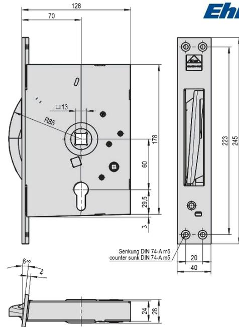
Artikel-Nr. 10943 Schneckenpresshebelschloss, DIN L für Tiefkühlraum-Drehtür Typ „VE“
