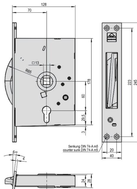
Artikel-Nr. 10942 Schneckenpresshebelschloss, DIN R für Kühlraum-Drehtür Typ „KE“
