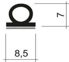
Artikel-Nr. 11974 Sanierungsdichtung für Kellertür Typ „KFE“
