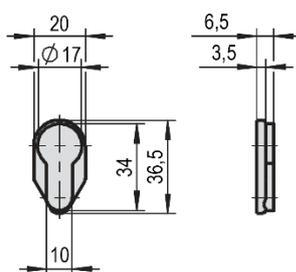
Artikel-Nr. # PZ-Abdeckung, Füllstück für Kühlraum-Drehtür Typ „KE“
