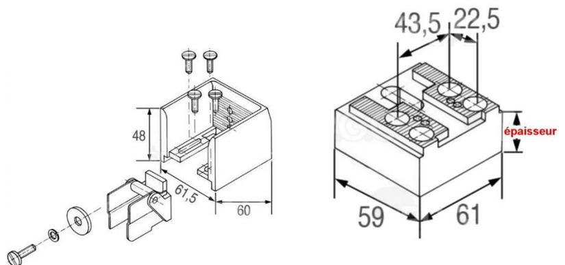
Artikel-Nr. 11793 Schließkloben für 30-43 mm Türblatt-Überschlag für Kühlraum-Drehtür Typ „KE“
