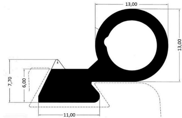
Artikel-Nr. 11007 Dichtungsgummi umlaufend für Tiefkühlraum-Drehtür Typ „VE“
