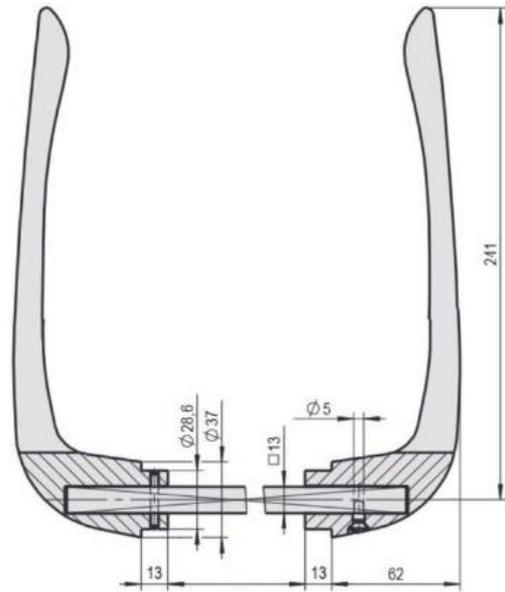
Artikel-Nr. 10211 Presshebel verchromt für Kühlraum-Drehtür Typ "KE" für Türblatt-Stärke 82-90 mm
