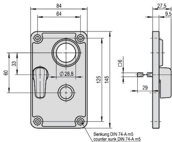
Artikel-Nr. 10958 Kunststoff Innenschild mit Notauslösevorrichtung für Kühlraum-Drehtür Typ „KE“
