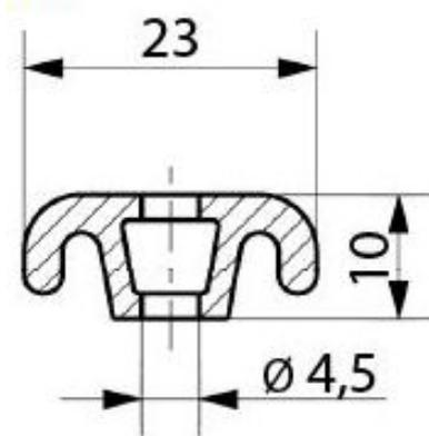
Artikel-Nr. 11734 Befestigungsleiste für Bodengummi Typ „LTS/LKS/LBS“
