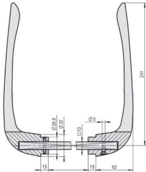
Artikel-Nr. 10212 Presshebel verchromt für Tiefkühlraum-Drehtür Typ „VE“ für Türblattstärke 133-141 mm
