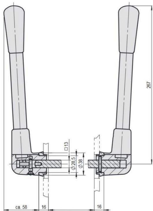
Artikel-Nr. 10952 Presshebel Edelstahl für Kühlraum-Drehtür Typ „KE“ für Türblatt-Stärke 82-90 mm
