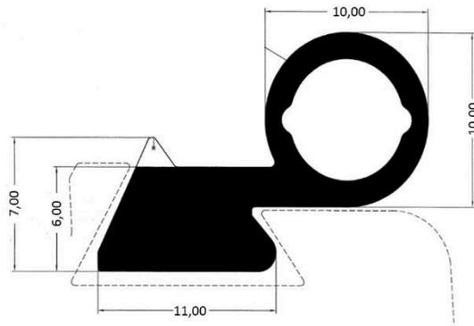
Artikel-Nr. 11006 Dichtungsgummi für Betriebsraum-Drehtür Typ „Gastro 2 KE“
