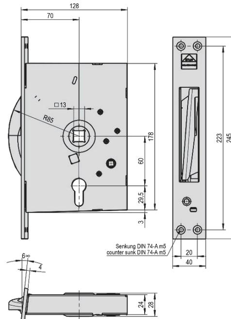
Artikel-Nr. 10942 Schneckenpresshebelschloss, DIN R für Tiefkühlraum-Drehtür Typ „VE“
