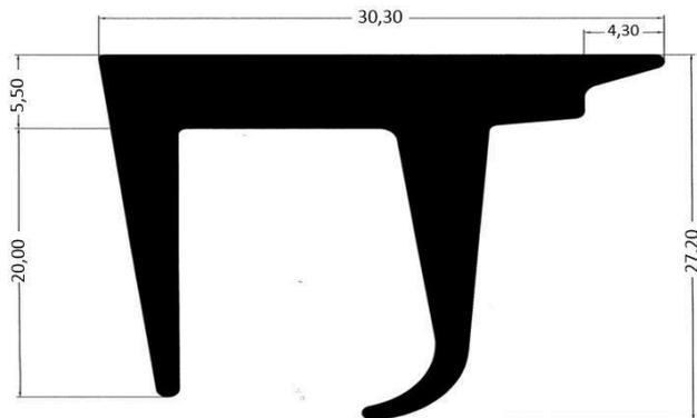
Artikel-Nr. 11005 Bodengummi mit Aluleiste für Tiefkühlraum-Drehtür Typ „VE“
