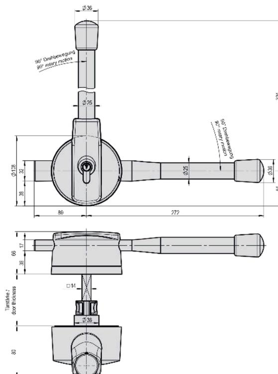
Artikel-Nr. 13700 EURO 5000 Presshebel für Kühlraumtür-Drehtür Typ „KE“ für Türblatt-Stärke 82-90 mm
