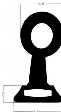
Artikel-Nr. 11008 Dichtungsgummi für Kühl-/Tiefkühlraumschiebetür Typ „EKS/ETS“
