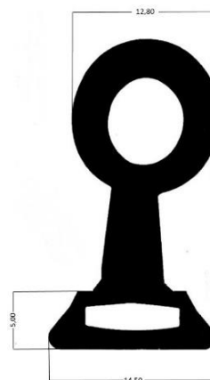
Artikel-Nr. 11008 Dichtungsgummi für Schiebetüren Typ „LBS/LKS/LTS“
